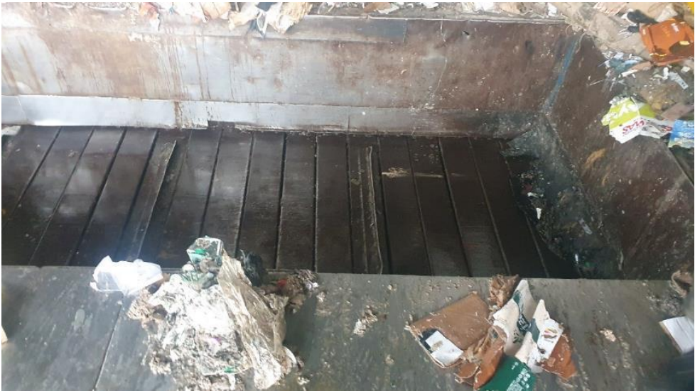
Figura 26. Vista de las instalaciones de la nave de Tratamiento II. Detalle de la cinta de la clasificadora a desmantelar.
